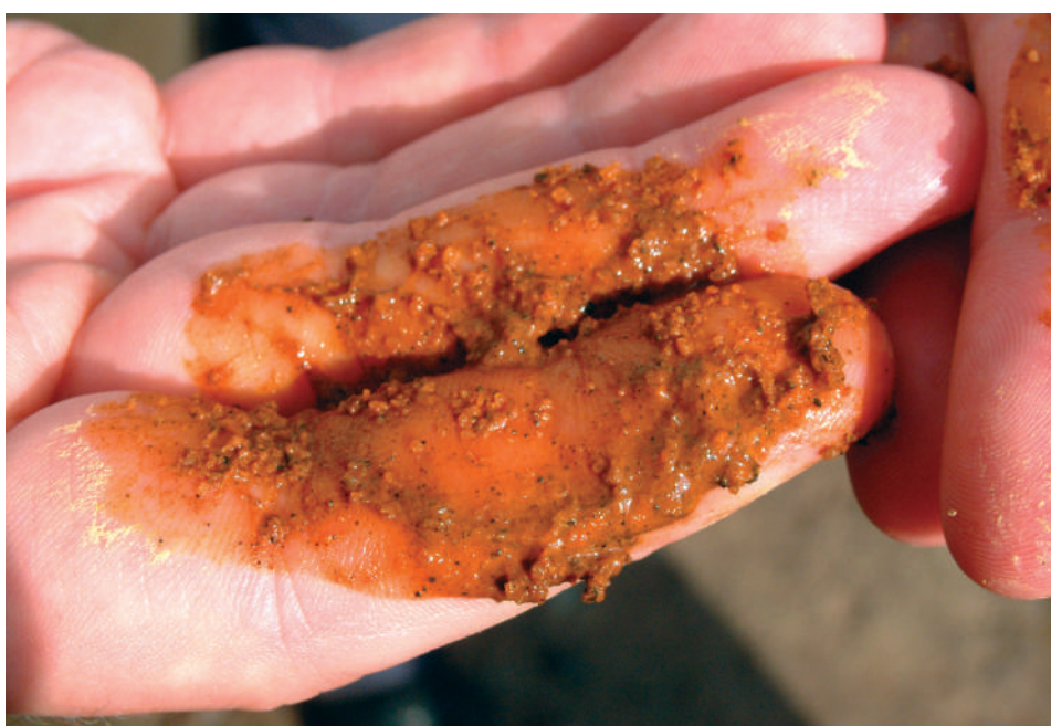
Mynd 10.11. Jarðvegssýni frá Asoreyjum sem sýnir kvikuhegðun. Kögglinum (til vinstri) var velt nokkrum sinnum í lófanum (rask) sem olli því að moldin náði flæðimarki (til hægri). Dæmigerð kvikuhegðun eldfjallajarðar sem m.a. útskýrir hættu á skriðum í hlíðum.
